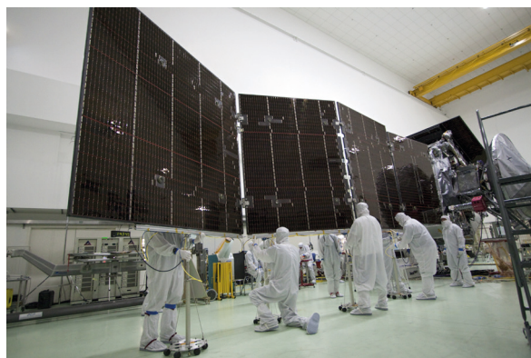
A Jupitert kutató Juno űrszonda napelemtábláinak ellenőrzése (Forrás: NASA)
