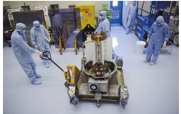
A Curiosity marsjáró számára készült radioizotópos termoelektromos generátor laboratóriumi tesztje (Forrás: NASA)
