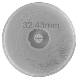
9. ábra. A gátlási zóna átmérőjét a fényképekről program segítségével (az egyes pixelek színe alapján) határoztuk meg
