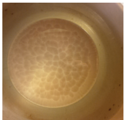
8. ábra. Melegedő kakaóban kialakuló áramlást ábrázoló fénykép, melyhez hasonló bárki saját maga is készíthet
