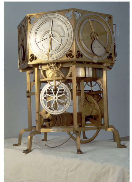
Giovanni Dondi dell'Orologio által 1348 és 1364 között készített asztrárium (csillagászati óra) rekonstrukciója. 7 példány készült, ez a Leonardo da Vinci Múzeumban (Milánó) található. Kb. 80 kg és csaknem 1 m magas
