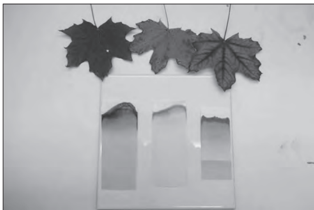
10. ábra. Papírkromatográfiás vizsgálat (balról: zöld, sárga, illetve piros levél)
