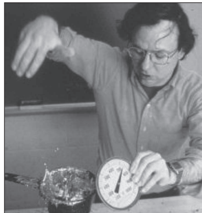
4. ábra. A víz párolgáshője megvédi a bőrt a forró ólomtól
