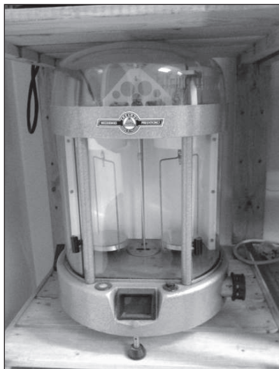
8. kép. A jelenleg is használt 1973 típusú analitikai mérleg
