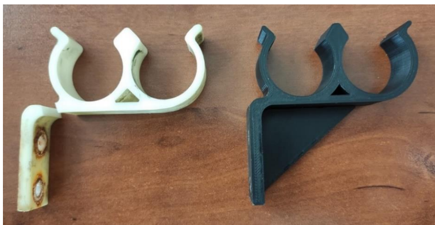
5. számú ábra. Az eredeti alkatrész és a merevítéssel ellátott 1.1 verziószámú pótalkatrész első legyártott próbadarabja 19
