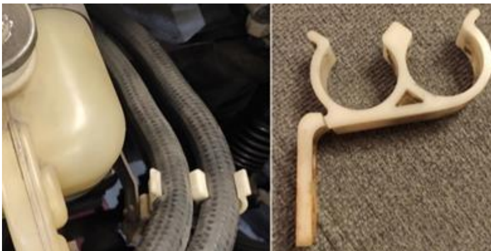
1.számú ábra. Az eredeti, sérült alkatrész beszerelt és kiszertelt állapotban 9
