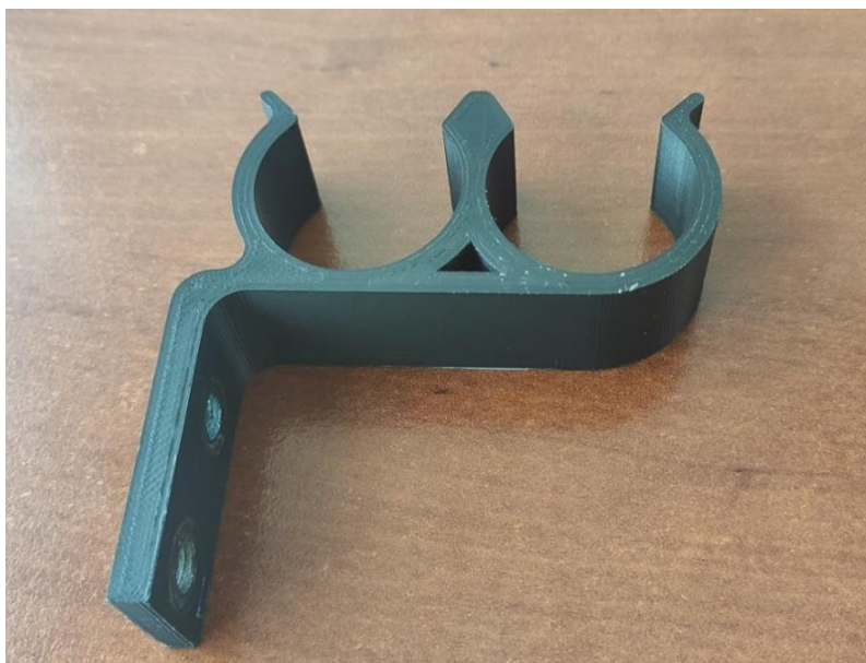
3. számú ábra. Az 1.0 pótalkatrész első legyártott próbadarabja 16
