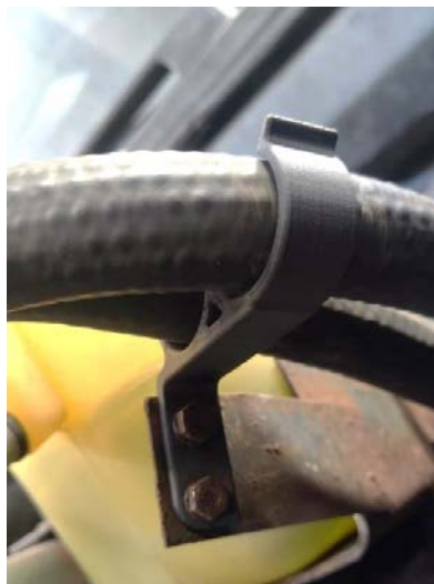
12. számú ábra. A 2.1 verziószámú, végleges alkatrész beszerelt állapotban 34
