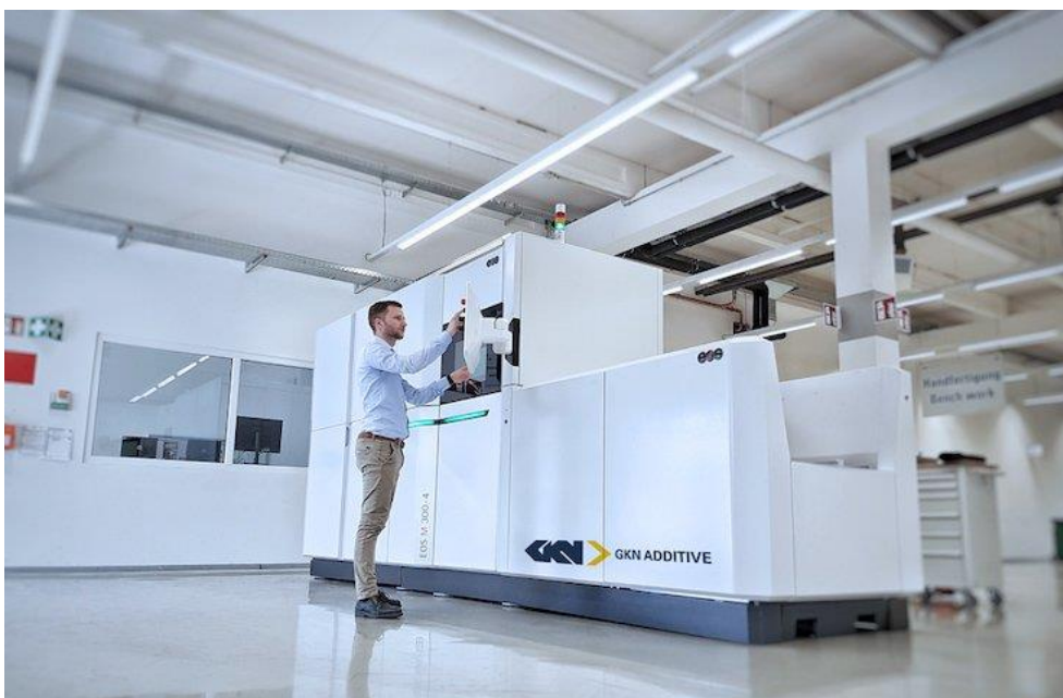
2. számú ábra. Egy jól képzett EOS M 300-4 típusú ipari 3D nyomtatóállomás [10]. Ezek a gépek a műanyag nyomtatókkal szemben nem férnek el egy asztalon
