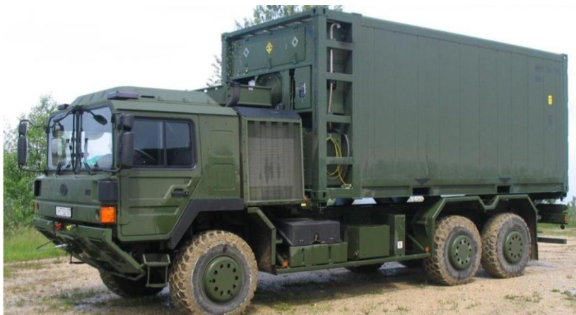
3. számú ábra. A Magyar Honvédségnél rendszeresített Rába MAN H25 konténerszállító terepjáró tehergépkocsi egy 20 lábás szabványkonténer szállítására alkalmas [12]
