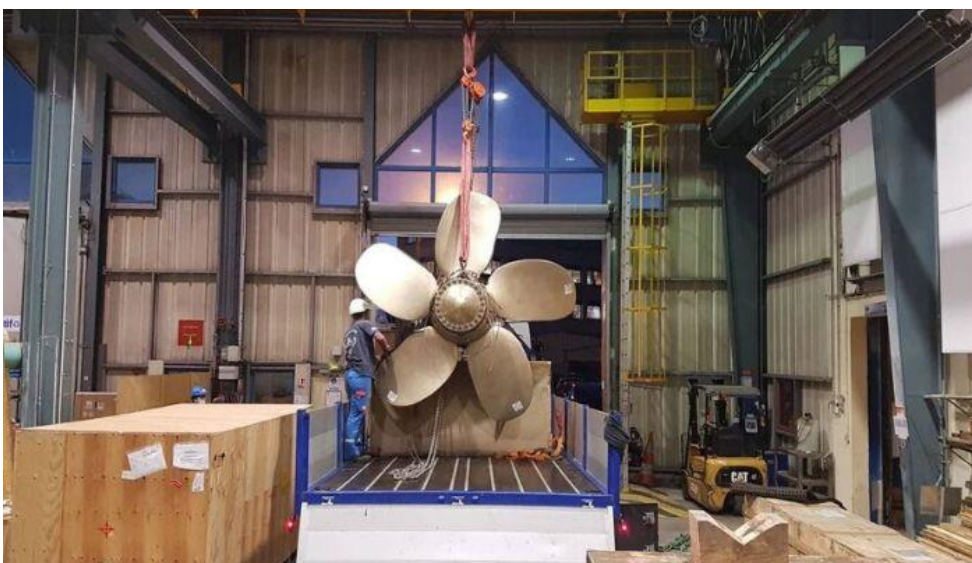
1. számú ábra. 3D nyomtatással készített hajócsavar [4]
