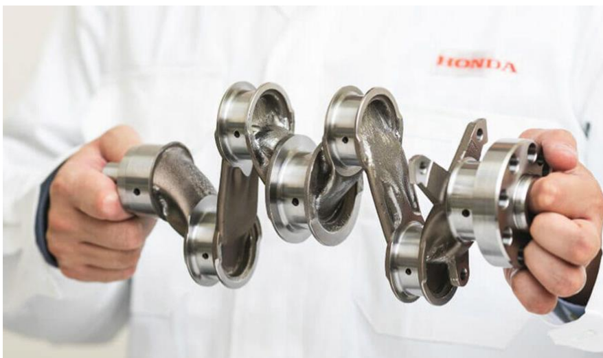
12. számú ábra. A Honda és az Autodesk közös projektjében tervezett és 3D nyomtatott forgattyústengely 34
