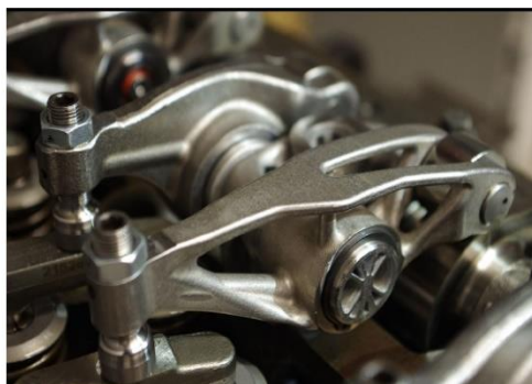
13. számú ábra. Renault DTI 5 motor eredeti szelephimbája (bal oldali kép) és a 3D nyomtatott könnyített szelephimba (jobb oldali kép) 37
