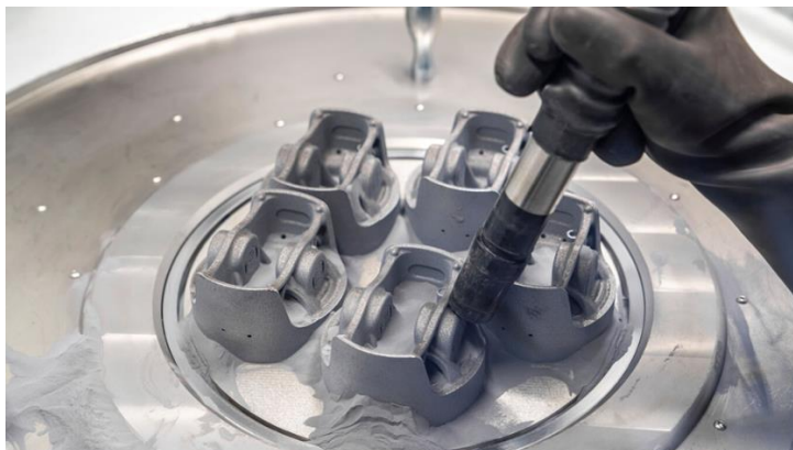
11. számú ábra. A Porsche 911 GT2 RS szelektív lézeres olvasztással előállított dugattyúja 31
