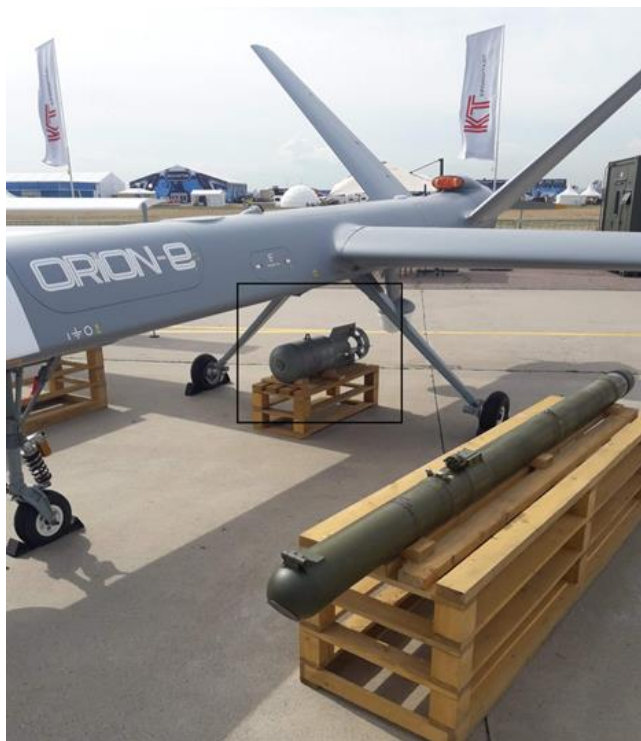
1. számú ábra. MALE-kategóriájú, turbódízelmotoros orosz Orion UAV és Kornet rakéta 6
