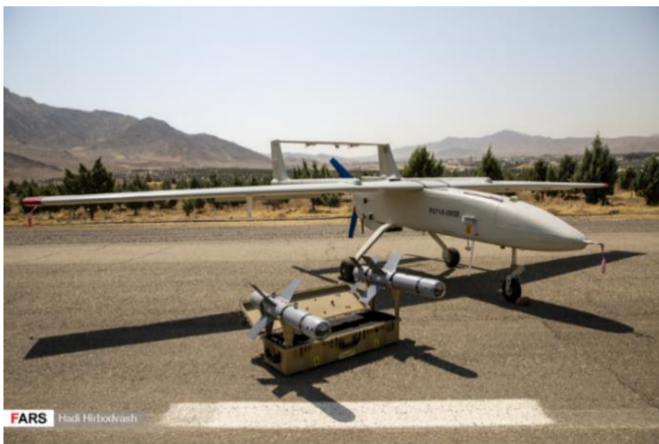
2. számú ábra. MALE-kategóriájú, 115 LE-s dugattyús motorral hajtott iráni Mohajer-6 UAV négy rakétával 7
