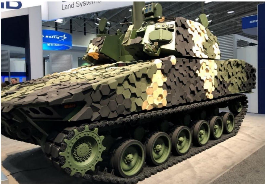
11. számú ábra. Griffin könnyű harckocsi speciális kerámia-kompozit páncélja [18.]
