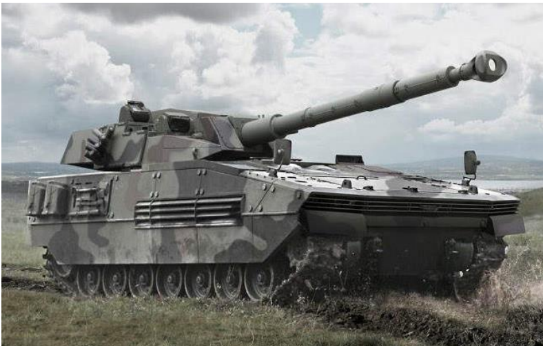
6. számú ábra. Otokar Tulpar könnyű harckocsi 105 mm-es harckocsiágyúval [9.]
