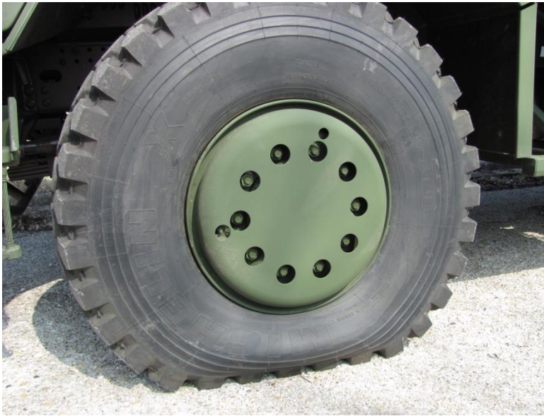
1. számú kép. Gumiabroncs-talajnyomás csökkentése a gördülőfelület megnövelésével.[6]
