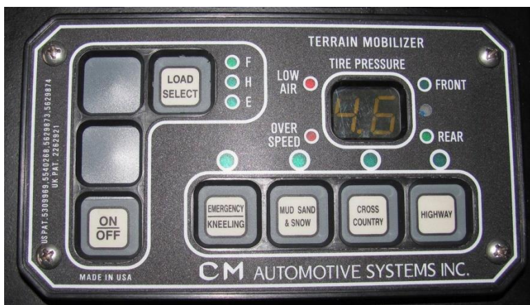
4/b. számú kép. A CMAS CTIS vezérlőegysége (ECU) [6]
