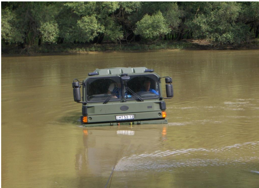
7. számú kép. Gázló-vizsgálat, a Mosoni-Duna Győr melletti folyamában, egy másik katonai jármű csörlőkötélével biztosítva.[6]
