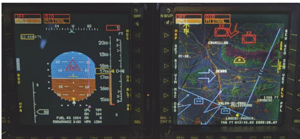
9. számú fénykép. A Tiger helikopter Elsődleges Repülési Adat (PFD) és Harcászati Helyzet Kijelzői 16
