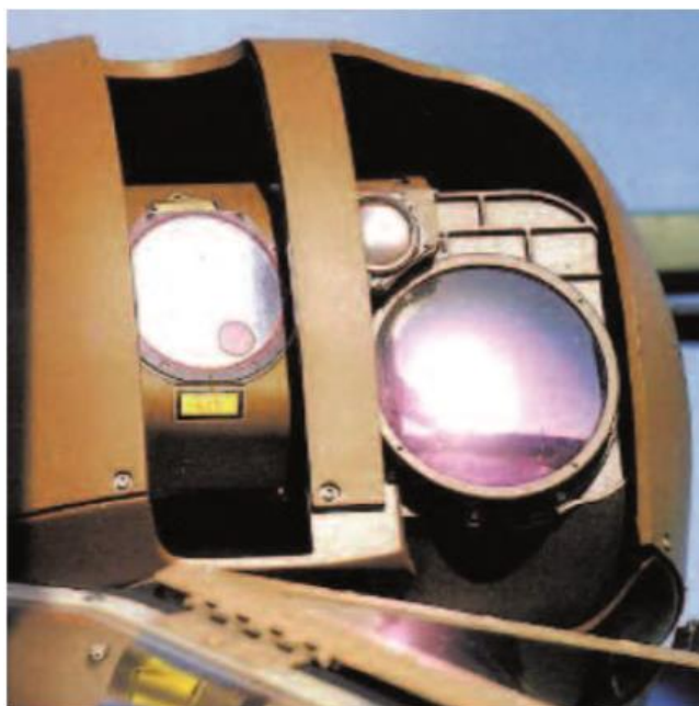
12.számú fénykép. A Tiger helikopter girosztabilizált kamerarendszere 18
