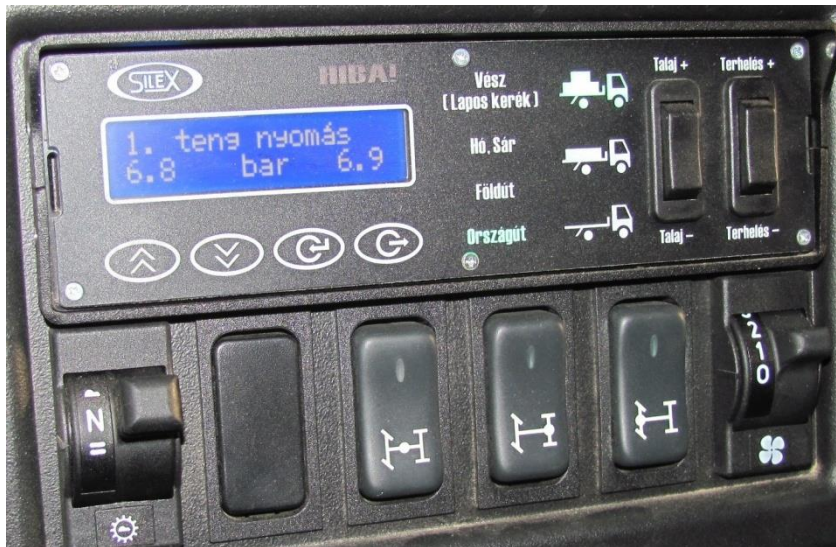
8. számú kép. RÁBA H14.240 típusú járműbe épített SILEX CTIS vezérlő egysége (a jármű 1. tengelyének mért abroncsnyomásait jelzi). [6]
