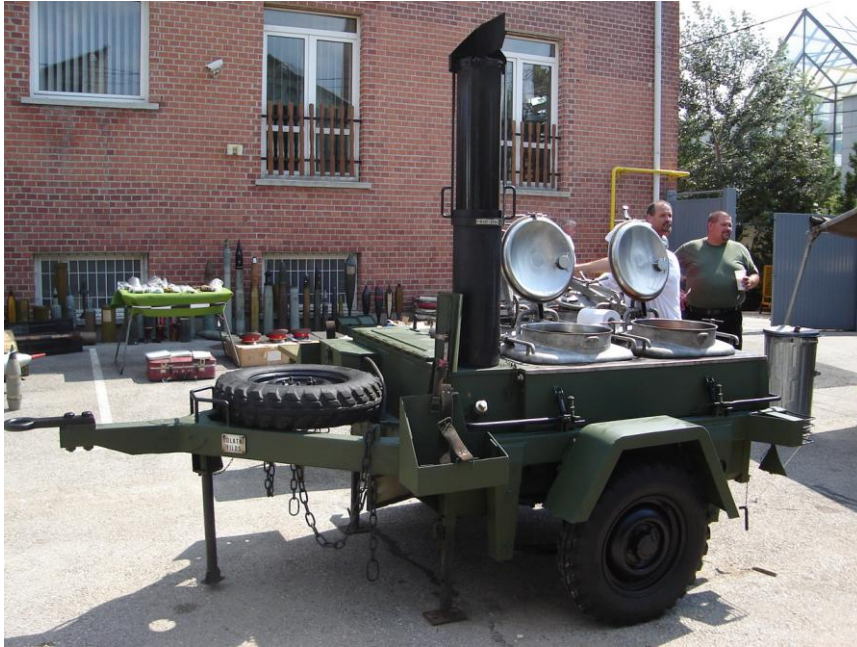
6. számú ábra. A 69M vegyes tüzelésű mozgókonyha 120 fő ellátására (250 egytálétel) alkalmas
