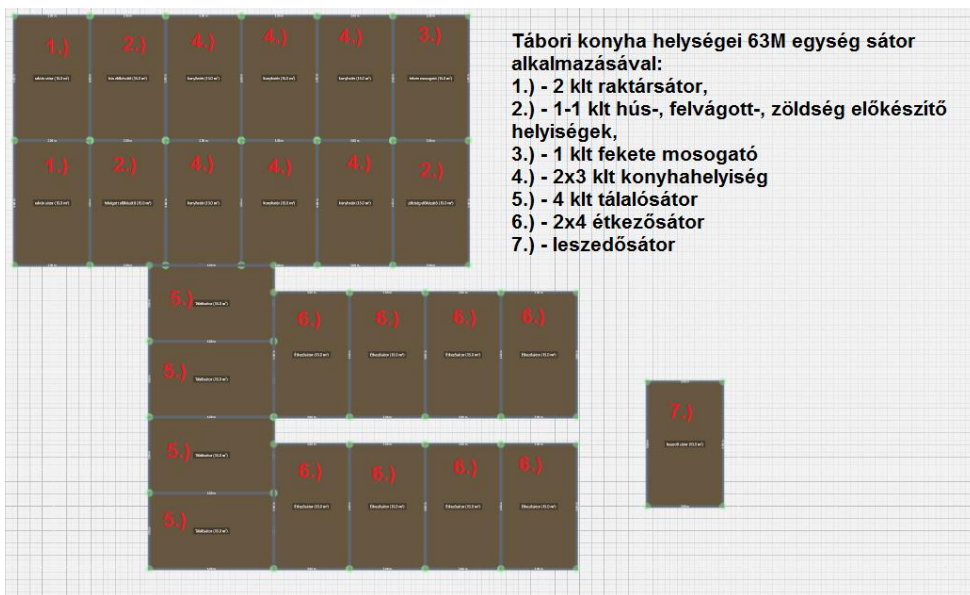
7. számú ábra. 63M sátor alkalmazásával kialakított tábori konyha egy lehetséges változata
