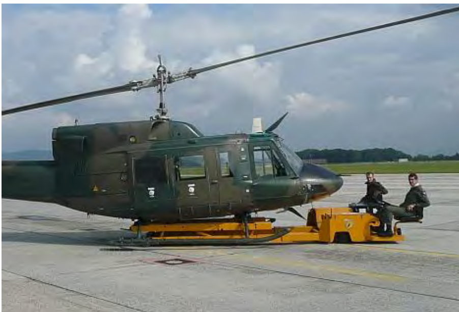
11. ábra. Az UH-1N olasz változata, az AB-212. A merevfutós helikopter földi mozgata speciális eszközt (pl. elektromos szállítókoszt vagy kerekes vendégfutót) igényel
