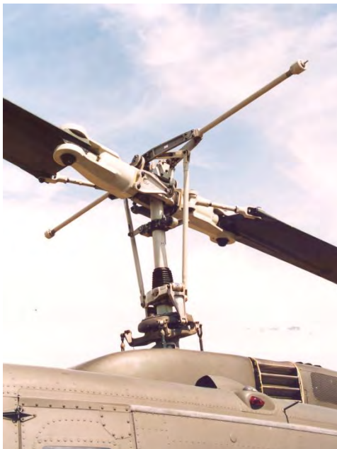
4. ábra. A rotorlapátokra merőlegesen elhelyezett rudak a rotorvezérlésnél, végükön a kiegyenlítő súlyokkal
