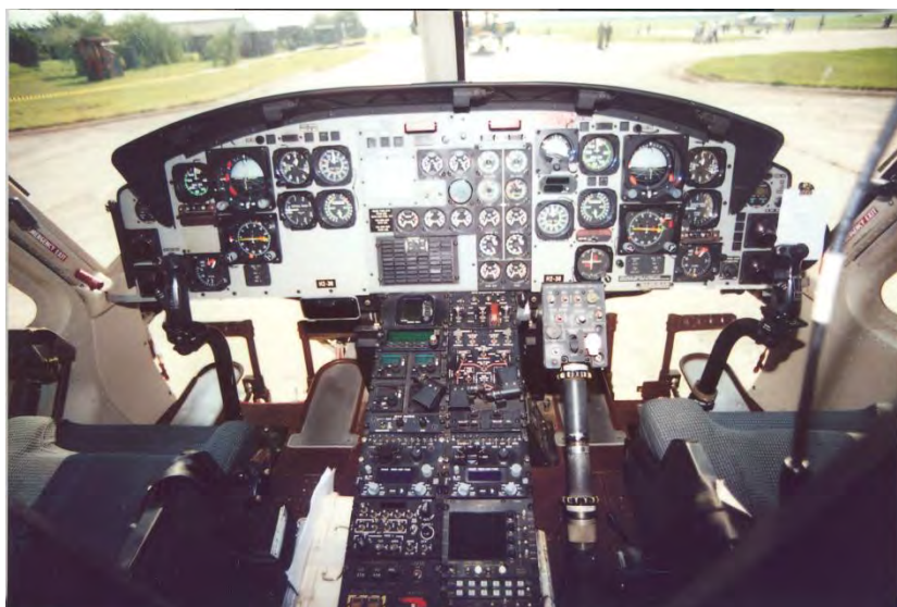
5. ábra. Az UH-1 helikopter műszerfala
