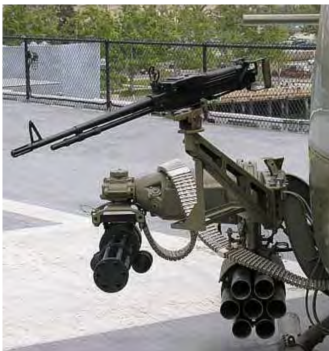
15. ábra. Az UH-1 Gunship (felfegyverzett támogató-helikopter) fegyverzete
