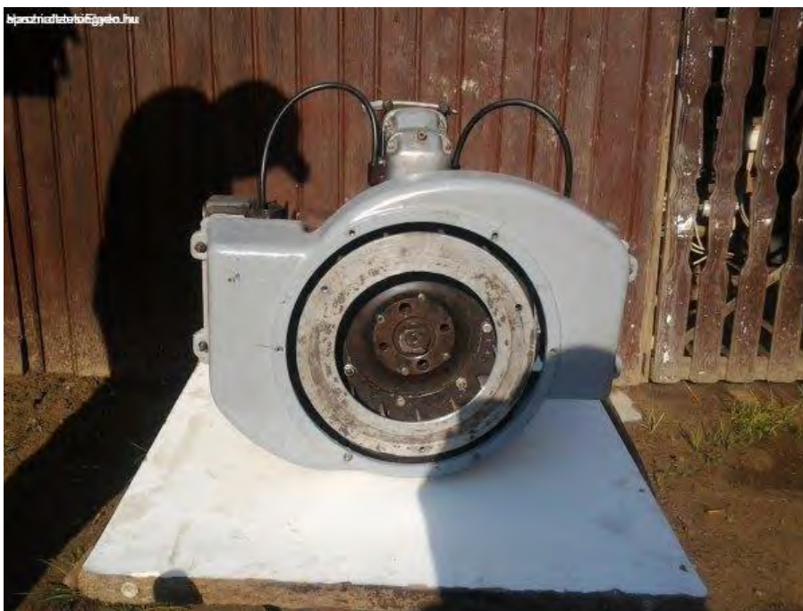
9. ábra. A kényszerlégűtéses boxermotor ventilátora és légtelőr-burkolata
