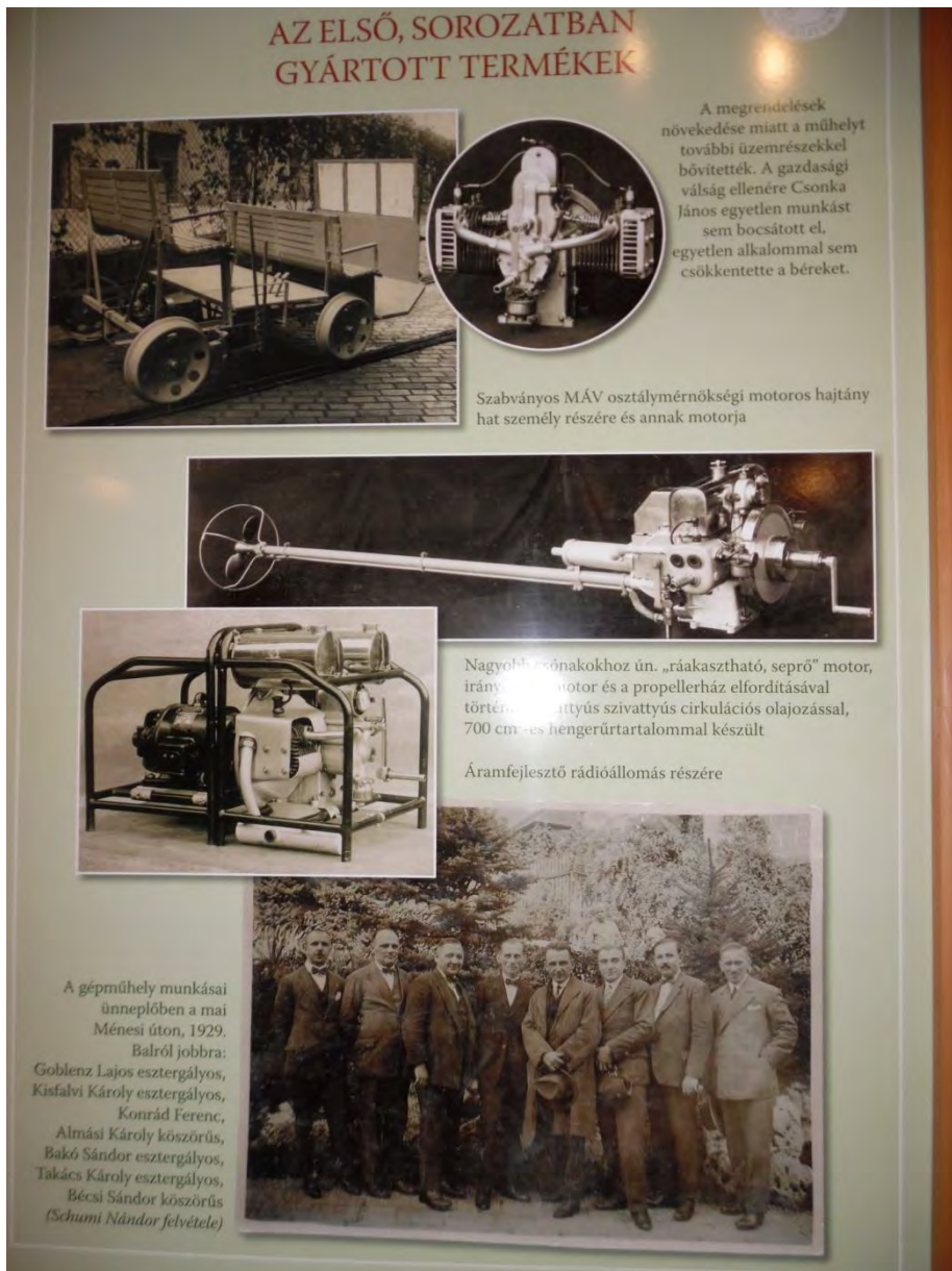
3. ábra. A Csonka léghűtéses boxermotorok alkalmazása vasúti hajtányban, csónakmotorban, illetve aggregátormotorként (Csonka János Múzeum)
