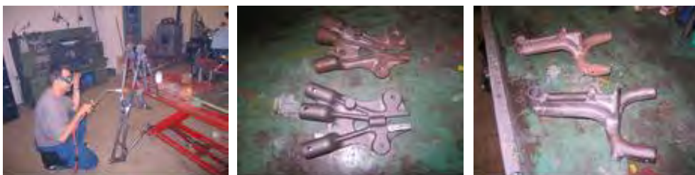
27. ábra. Méray motorkerékpár vázának és csomóponti vázöntvényeinek előállítását egy hazai motorkerékpár-építő műhelyben
