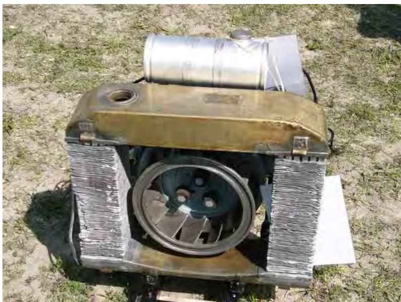
10. ábra. A vízhűtő kialakítása a TM-650/2 boxermotoron
