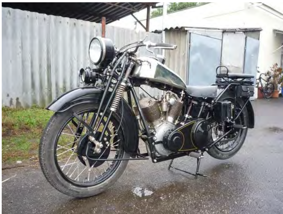
18. ábra. Méray motorkerékpár brit eredetű JAP V-motorral, 1936
