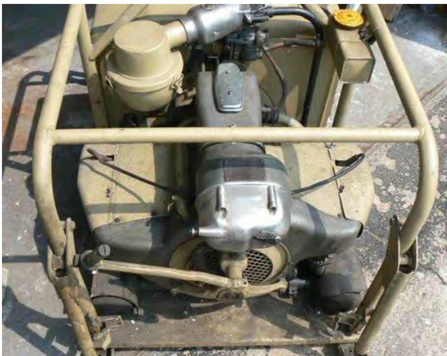
17. ábra. Német gyártmányú 600 cm 3 -es boxermotoros aggregátor (Stromaggregat: áramaggregátor) a II. világháborúból
