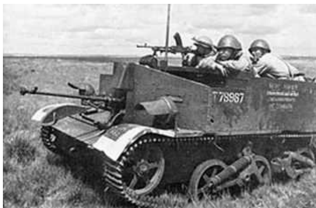
25. ábra. A Boys páncéltörő puskát egyes páncélautókba, szállítójárművekbe építve is használták, mint például a képen látható Universal Carrier vagy a Standard Beaverette
