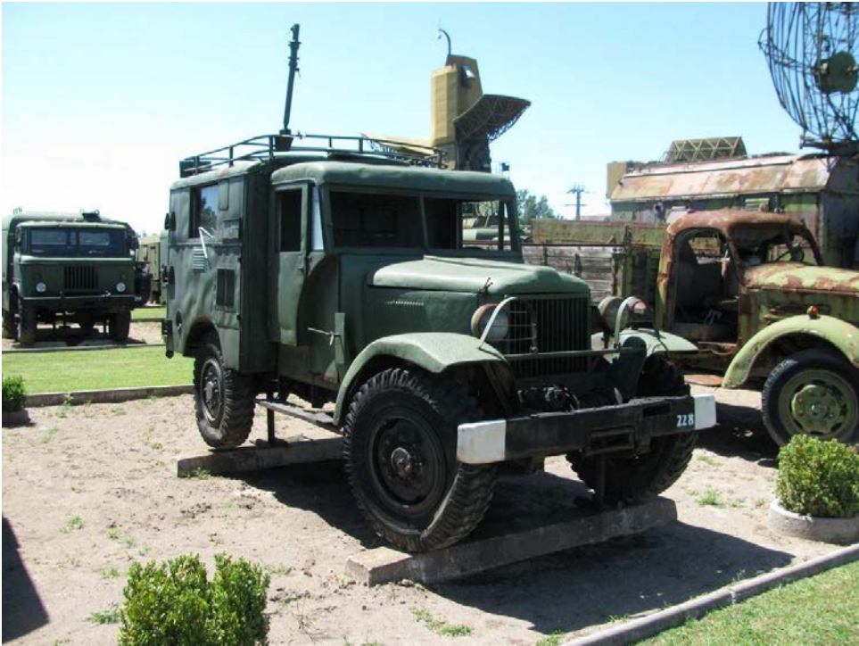
7. ábra. R-30 rádióállomás Csepel B-130 alvázon, a HM Hadtörténeti Intézet és Múzeum kecelei haditechnikai parkjában
