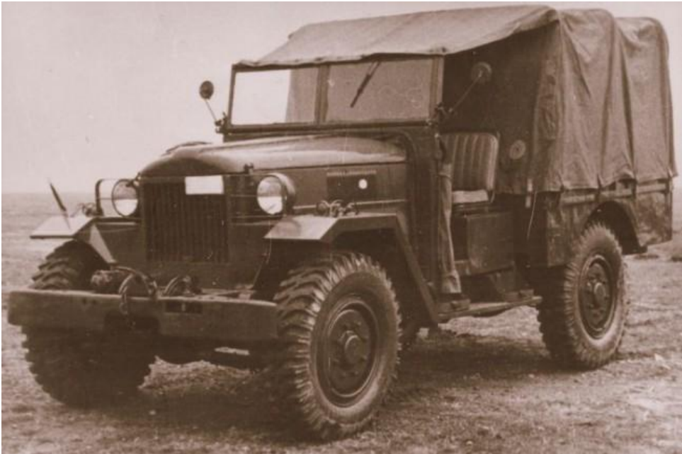
6. ábra. Cs-130 könnyű terepjáró rajgépkocsi ponyvatetővel
