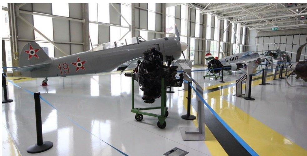
9. ábra. A JAK-11 vadász-gyakorló repülőgép, előtérben a Svecov AS-21 léghűtéses 7 hengeres csillagmotor
