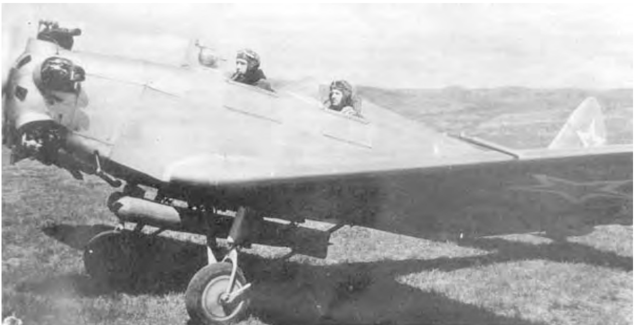
4. ábra. Az UT-2 repülőgép C változata gyakorló torpedóval
