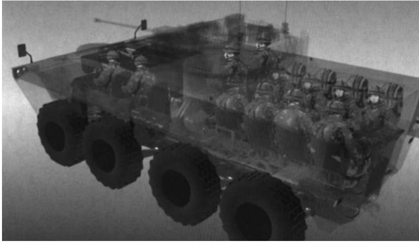
AMV 8 kerekes lövéspáncélos - változat belső tere.
