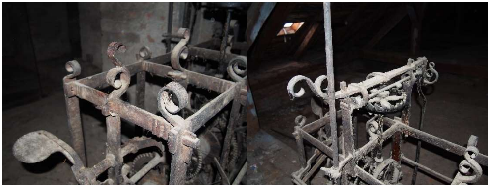
12–13. kép. Az Aszalai István által készített toronyóra pántvasainak műves kivitelezése és orsójáratú gátszerkezete.
