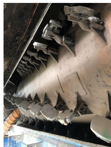
12. ábra: A külső dob felnyitásával láthatóvá válik a dupladobos rendszerű aszfaltkeverő gép belső dobpalástja a keverőlapátokkal.
