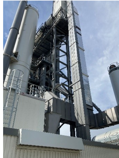
14. ábra: Párhuzamos dobbal ellátott, nagyteljesítményű aszfaltkeverőgép Németországban.
