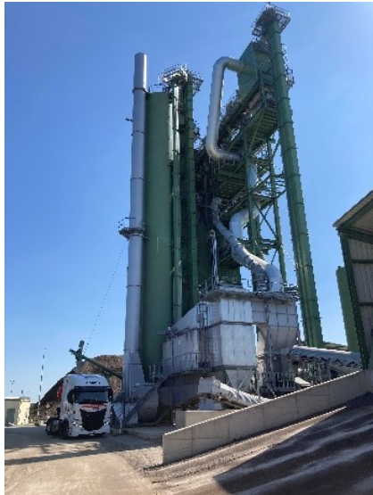
13. ábra: Párhuzamos dobbal ellátott, nagyteljesítményű aszfaltkeverőgép Ausztriában.
