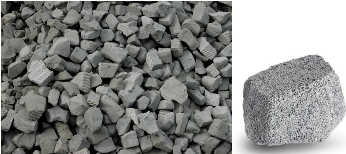
1. ábra: Üveghab-granulátum és üveghab szemcse.
