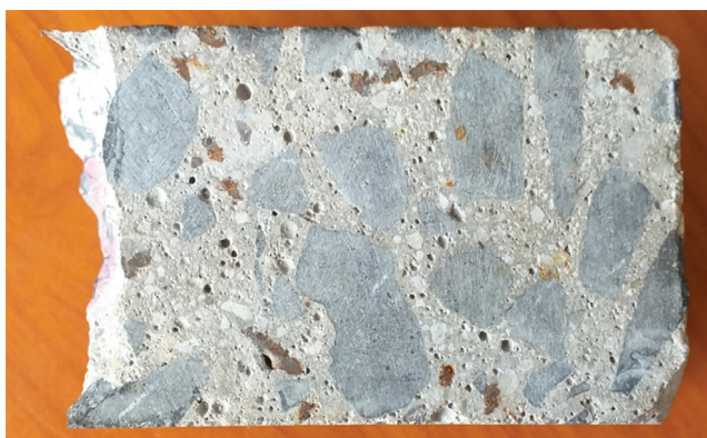
6. ábra. M7 gyorsbeton metszete (Fotó: Szentpéteri, 2019)
