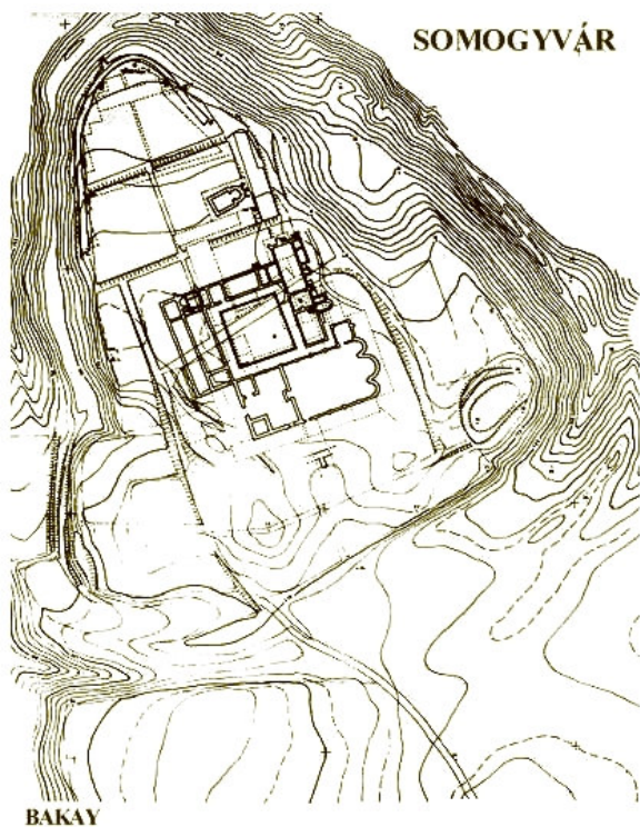
3.1. ábra: Somogyvár-Kupavár kolostorrá átépített várának felmérési alaprajza és helyszínrajza Alaprajzi négyzetmag mérete: ~40x40 m.
