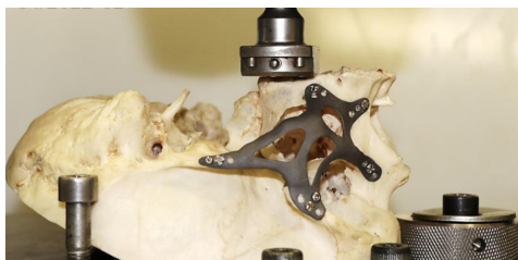
12. ábra. Egyedi implantátum végeeselemes modellezése és mechanikai vizsgálata
