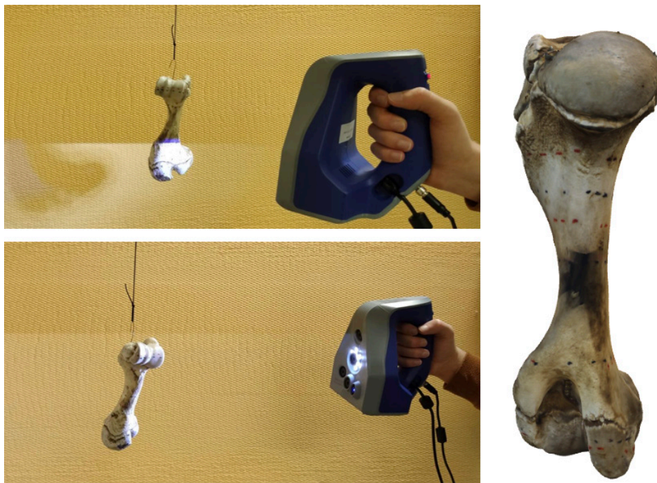
11. ábra. A valódi csontok 3D szkennerral történő digitalizálása és annak eredménye
