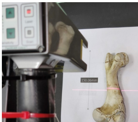
10. ábra. Metszési síkok bejelölése lézeres vonalvetítő segítségével
