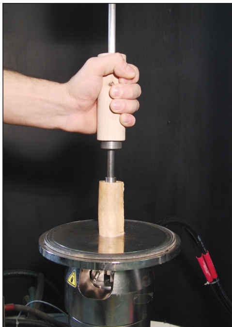
4. ábra. A kézi ütési vizsgálatok elrendezése
