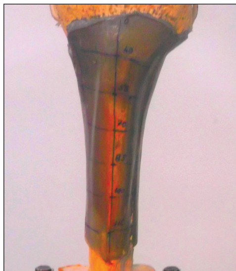
5. ábra. Rétegbevonatos optikai feszültségvizsgálat, referenciamérés
