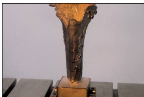
6. ábra. Feszültségoptikai vizsgálat, támasztólemezzel
