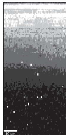
5. ábra. MMA-val kezelt UHMWPE minta metszetének RAMAN-spektruma
