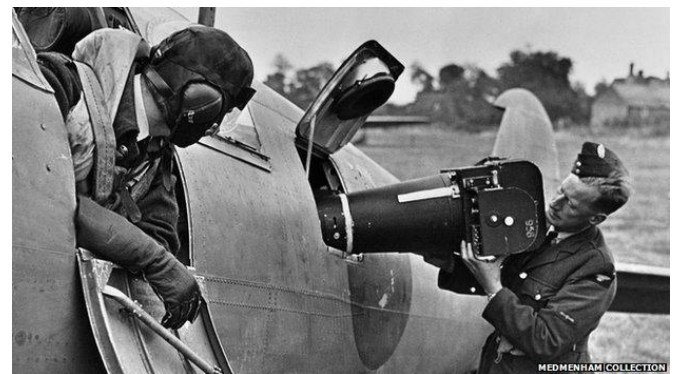
Egy Spitfire gyorsfelderítő vadászgép kamerájának beszerelése
