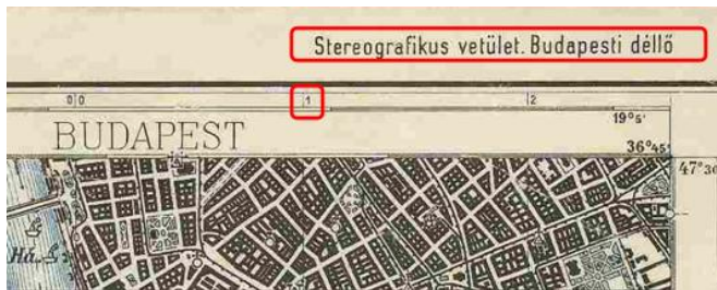
1. ábra A feliratokon és a koordinátákon is jól látszódik a budapesti sztereografikus rendszer. Forrás: 5062/1-es számú katonai sztereografikus térkép
