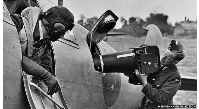
Egy Spitfire gyorsfelderítő vadászgép kamerájának beszerelése
