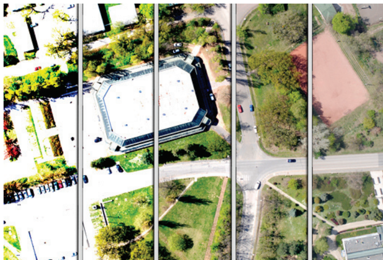
4. ábra. A Szent István Egyetem részlete különböző dinamikával. Megfigyelhető, hogyan változik a felvétel kiértékelhetősége az árnyalatgazdagság növekedésével.
