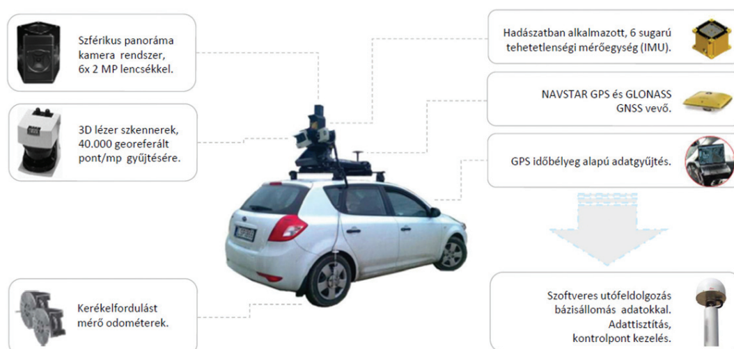
1. ábra. Mobil térképező rendszer működése
