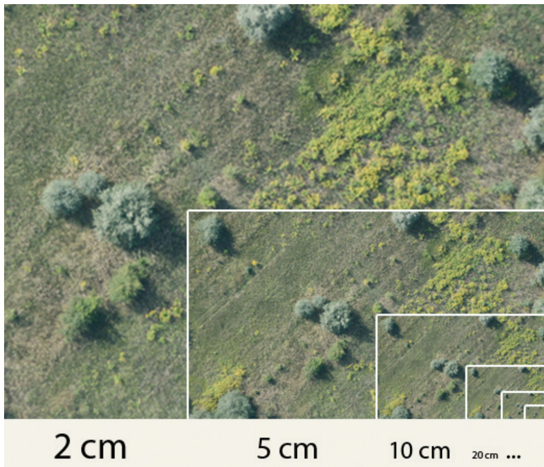
1. ábra. A terepi felbontás csökkenésével az objektumok felismerhetősége és pontos lokalizálásának esélye is csökken
