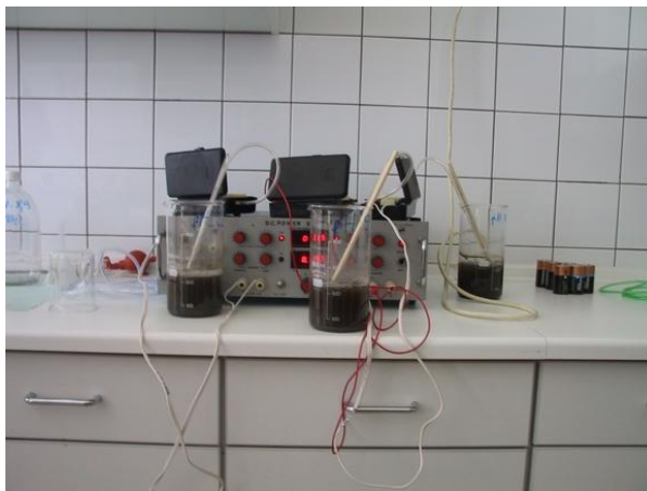
5. ábra: Az aerob biológiai szennyvíztisztítás laboratóriumi modellezése
