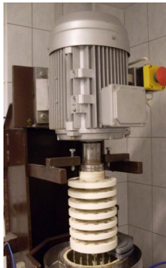
4. ábra: Kerámiabéléses, keverőmalom típusú mechanokémiai reaktor
