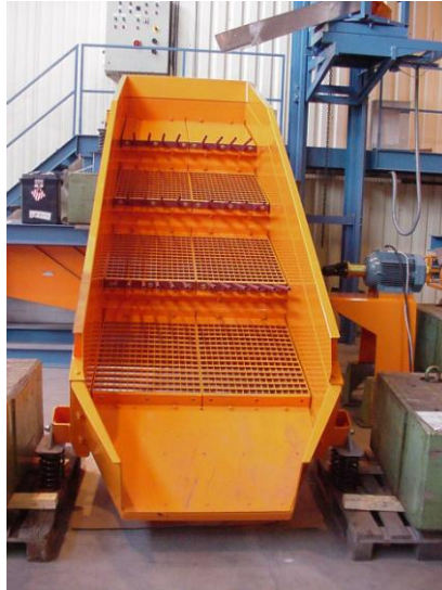
1.ábra Kaszkád hulladékszita és sematikus rajza [IFE GmbH]
