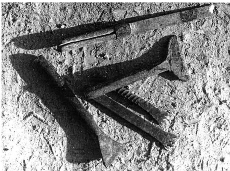
7. kép. Kőfaragó szerszámok: holker-, lapos- és fogasvésők
