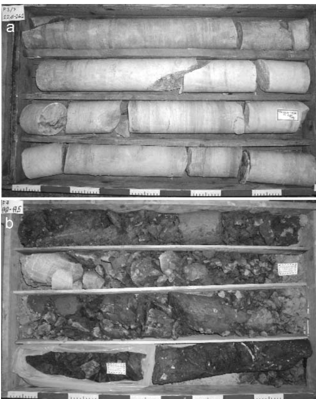
6. ábra. Eltérő tagoltságú és megjelenésű Budai Márga fúrásmintái a budai Várhegyről; a: blokkos, b: széteső tagoltságú
