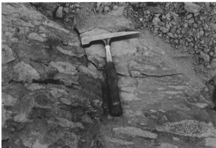
3. ábra. Porfir- és vasérc-törmelék egy apatit-magnetit matrixban. Rektorn fekükontaktusa
