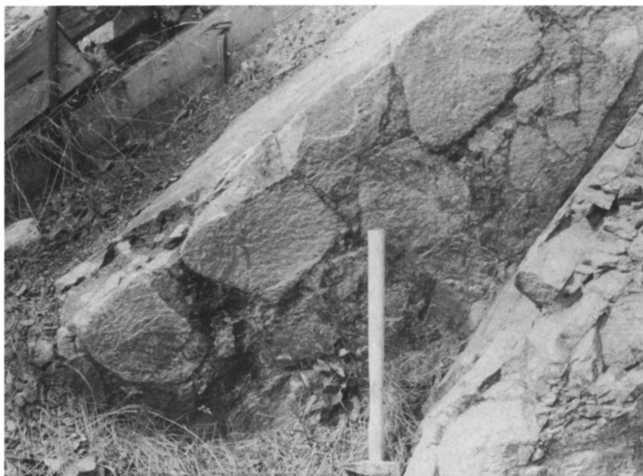
13. ábra. Valamelyest szállított porfirklasztikum magnetit matrixban. Kiirunavaara feküje
