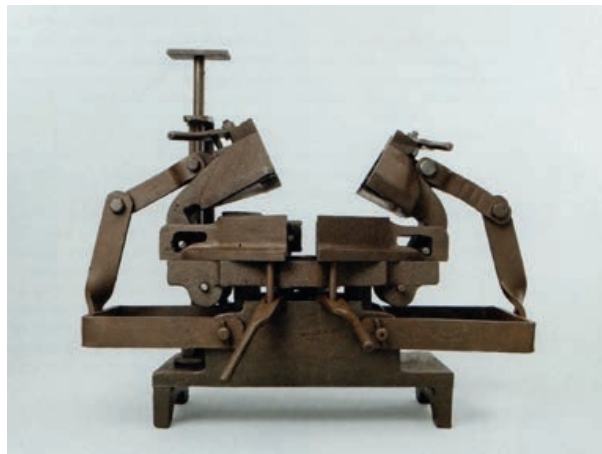
2. A 7-es üvegtégla fűjőformája Un rêve d'architecte 2018 (ld. 2. j.) 65.
