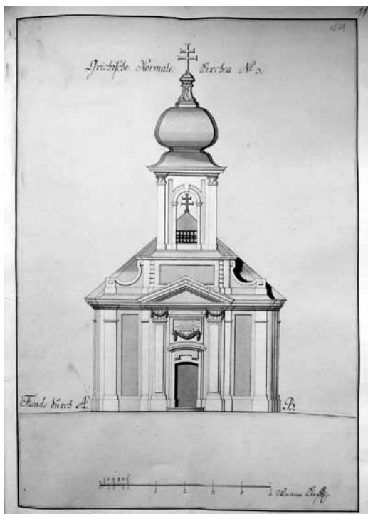
2. kép. Lorenz Lander: Típussterv görögkatolikus templomhoz, 1779 (3. változat, homlokzat). DAZO fond 151. opisz 1. Nr. 2531. f 11r
