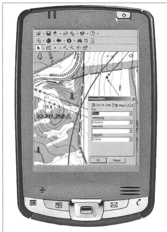
2. kép: Terepi adatrögzítés belső GPS-vevővel ellátott kézi számítógépen
