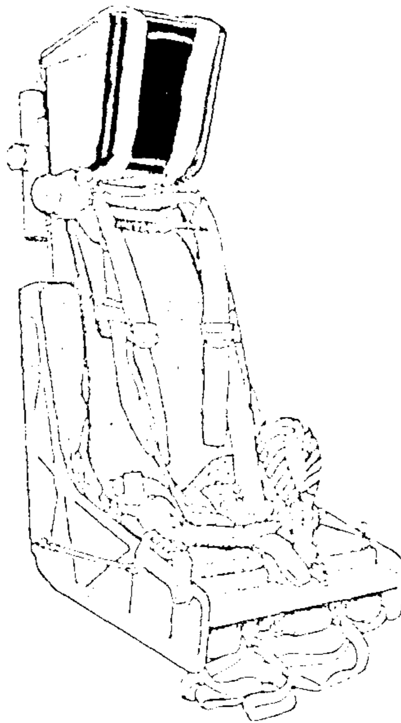
2. ábra Az MK-12 típusú MB katapultülés.
