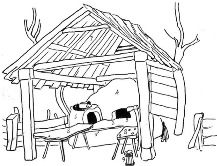
19. kép: Eszes Laciné nyári konyhája. 1. katlan, 2. tűszej, 3. tűszejfa, 4. kemence, 5. kemence függye, 6. üst, 7. konyha-fedél, 8. mosószek, 9. moslíkos.
